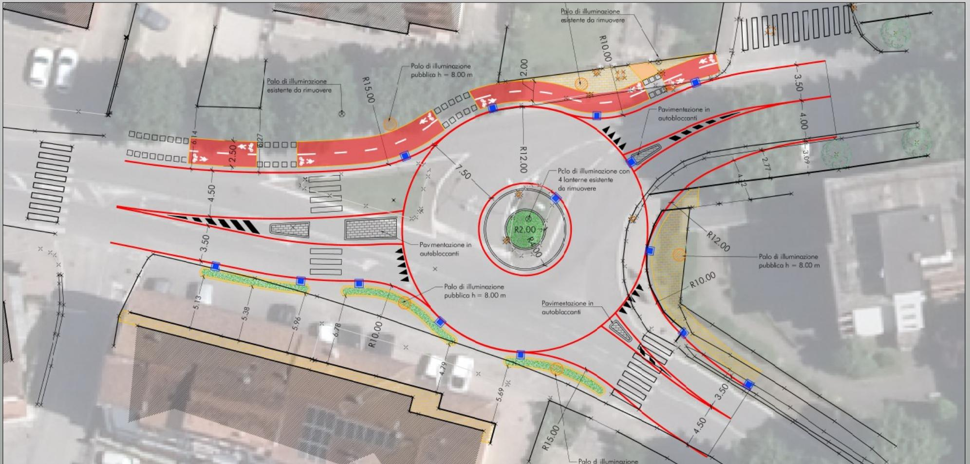
Mini rotatoria con diametro esterno m. 24,00 e isola centrale diametro m. 8,00
